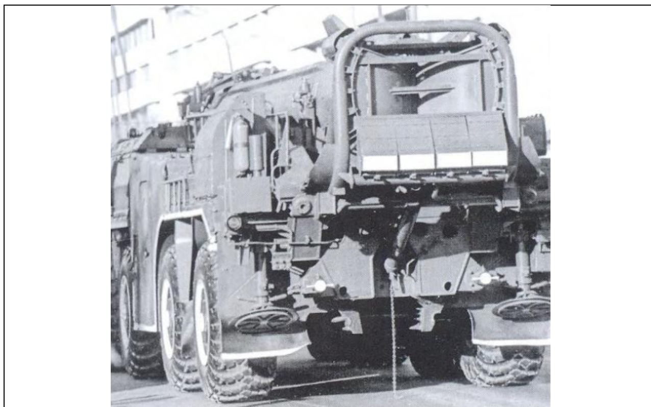
در این نمای پشت از سکوی پرتاب خودکششی 9P117M1 شوروی، قنداق پرتاب بزرگ 9N117 که هنگام حمل و نقل، پشت موشک لولا می‌شود به خوبی دیده می‌شود (وزارت دفاع آمریکا).
