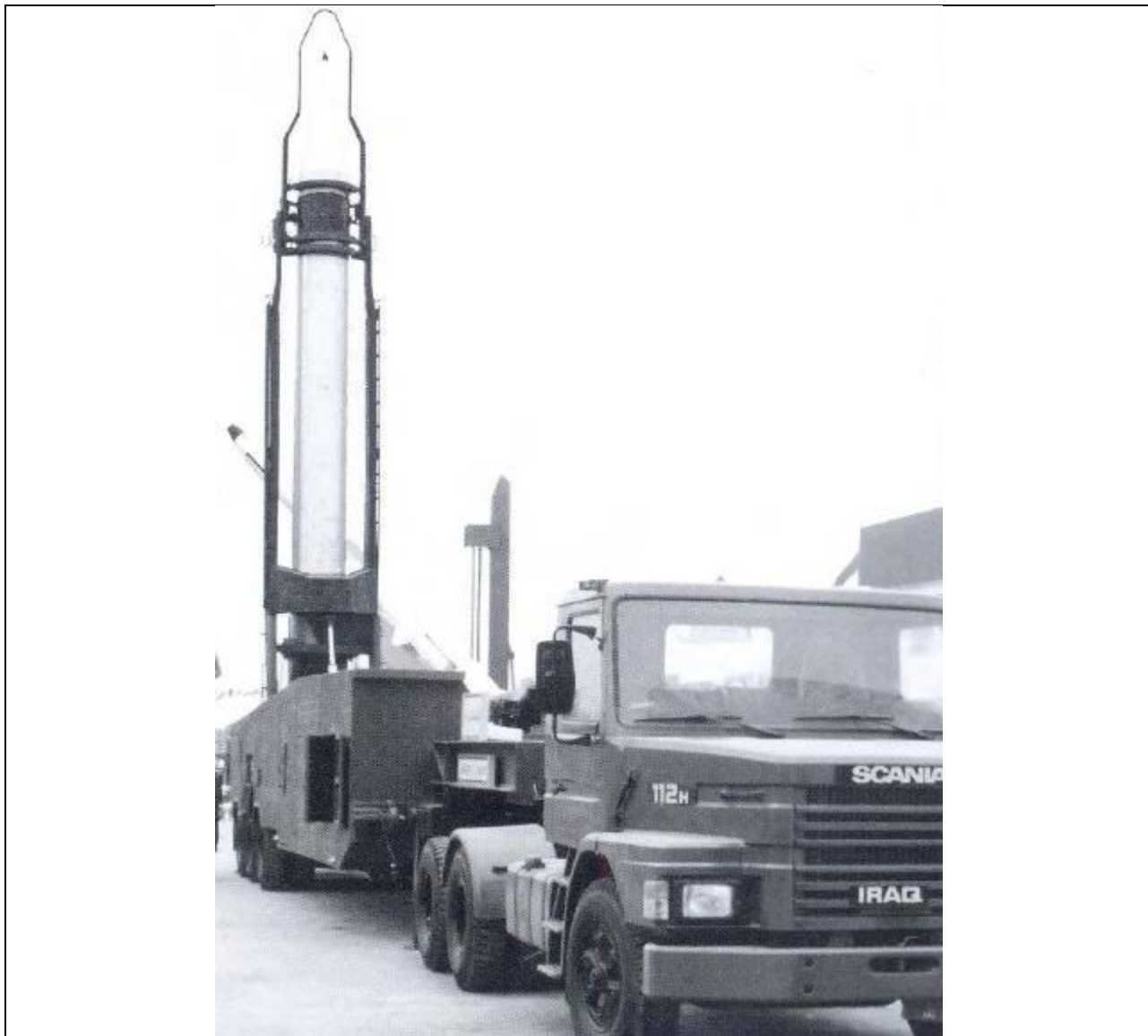
عراق سکوهای پرتاب خود، شامل الوافد که در این تصویر دیده می‌شود را برای تیپ ۲۲۳ توسعه داد. این سکوی نیم-کشنده از یک کامیون تجاری به عنوان خودرو محرک بهره می‌گرفت.
