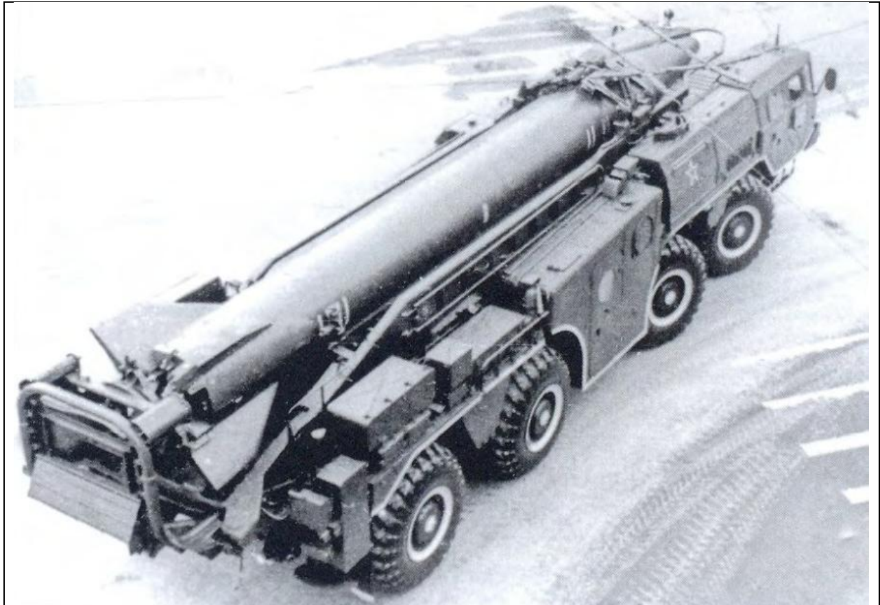
سکوی پرتاب خودکششی 9P117M یک چهارچوب عمودساز ساده داشت که فاقد ویژگی جرثقیل روکار با جکهای هیدرولیک مربوط به آن بود (وزارت دفاع آمریکا).
